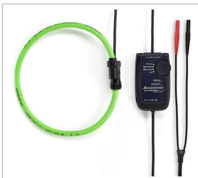
Flexibler Zangenstromsensor für selektive Erdungswiderstandsmessung
