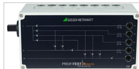
Zum Messen der Schleifen- und Netzimpedanz sowie Isolationswiderstand ohne lästiges Umstecken, Vertauschen usw.
