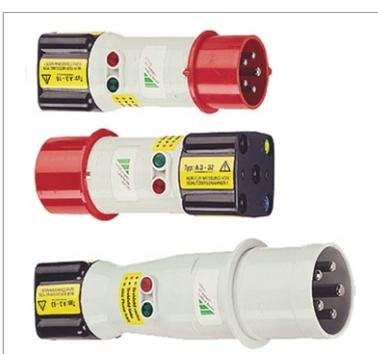
Die Drehstromadapter A3-16, A3-32 und A3-63 dienen dem problemlosen Anschließen von Prüfgeräten an 5-polige CEE-Steckdosen. Die drei Ausführungen unterscheiden sich durch die Größe des Steckers, der jeweils den 5-poligen CEE-Steckdosen mit den Nennströmen 16 A, 32 A, 63 A entspricht. Die Phasenfolge wird jeweils durch Lampen signalisiert. Die Prüfung der Wirksamkeit von Schutzmaßnahmen erfolgt über fünf berührungsgeschützte 4 mm Buchsen.
