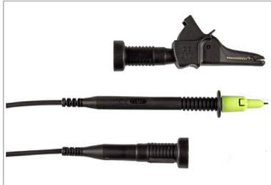
Das Kabelset KS24 besteht aus einem 4 m langen Verlängerungskabel mit fest angeschlossener Prüfspitze an einem Ende und einer berührungsgeschützten Buchse am anderen Ende sowie einem auf die Prüfspitze aufsteckbaren Krokodilclip.
