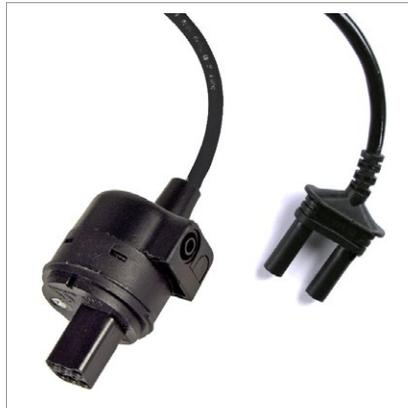
Adapter, der auf dem Prüfstecker montiert wird, zum Anschluss der Generatorzange E-Clip 2 für die 2-Zangen- oder Erdschleifen-Erdungswiderstandsmessung.
